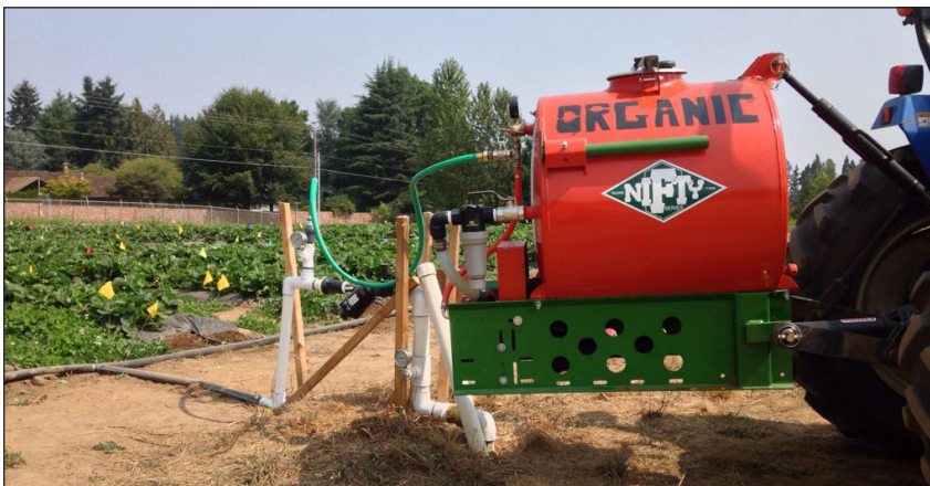
Figura 9. Fertirrigación de fresas orgánicas certificadas (de día neutral) utilizando una bomba y un tanque accionados por toma de fuerza.
